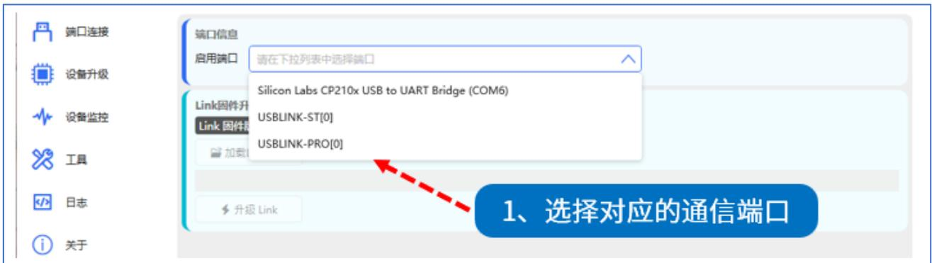
若端口启用正常，软件左下方将显示 [Link 已连接](#)。
